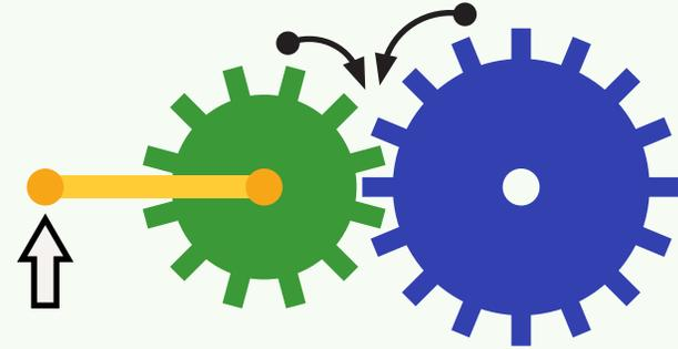
Il y a une **augmentation** de vitesse si le mouvement est transmis d'une grande roue vers une petite roue (Rapport > 1).
