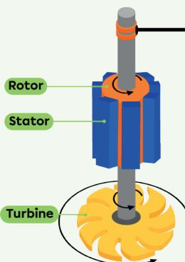
Dans un groupe turbine-alternateur, la rotation du rotor dans le stator fixe génère un courant électrique.
