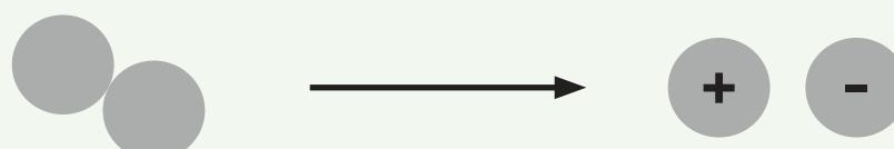
Induction : Une charge à proximité entraîne un déplacement temporaire des électrons.
