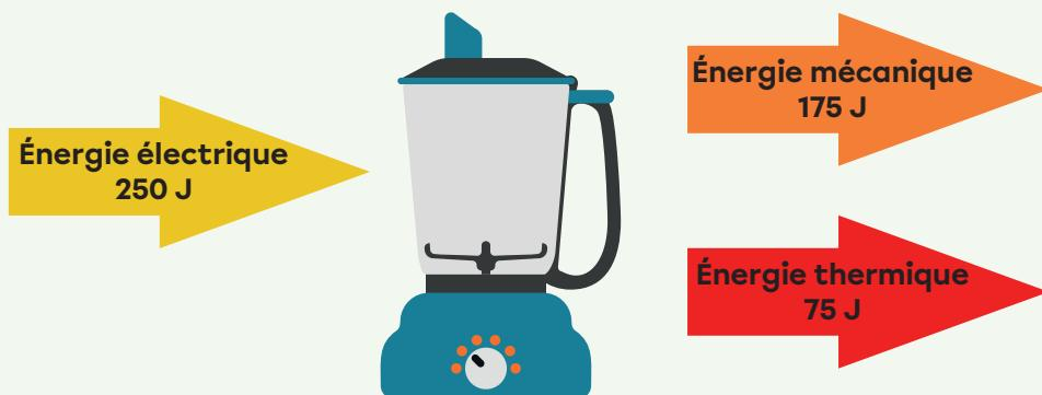
$$\begin{array}{rclclclcl} \text{Énergie consommée} & = & \text{Énergie utile} & + & \text{Énergie dissipée} \\ 250 \text{ J} & = & 175 \text{ J} & + & 75 \text{ J} \\ 250 \text{ J} & = & & & 250 \text{ J} \end{array}$$
